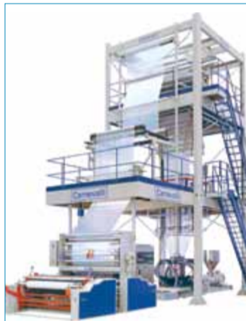
Linha de extrusão configurada para filmes de alta densidade, POLARIS MAGNUM 75-2000
