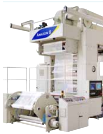
Impressora flexográfica de 8 cores, AMAZON 8-1200 HT
